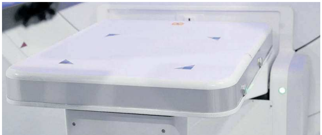
'Flat panel' que sirve para recoger los datos en tiempo real.
